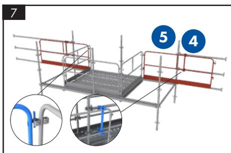
7 Mise en place des 2 garde-corps coulissants et des 2 supports garde-corps à ± 25 cm des montants.
