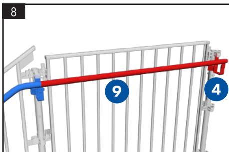
Mise en place du tube MC P150 (#9) et d'un support fixe (#4) au montant MultiCRAB.
