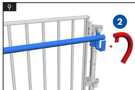
Pour la mise en place de la crosse de départ/arrivée, le goujon du support fixe doit être démonté afin de permettre l'installation de la crosse qui est déjà équipée du goujon de jonction.
