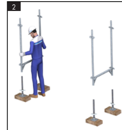
• Mise en place des cadres de départ.
