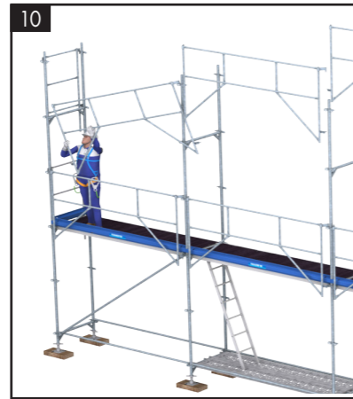
• Installation des garde-corps de sécurité MDS (courant et de rive) du niveau supérieur.
