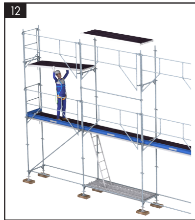
• Installation des planchers.
